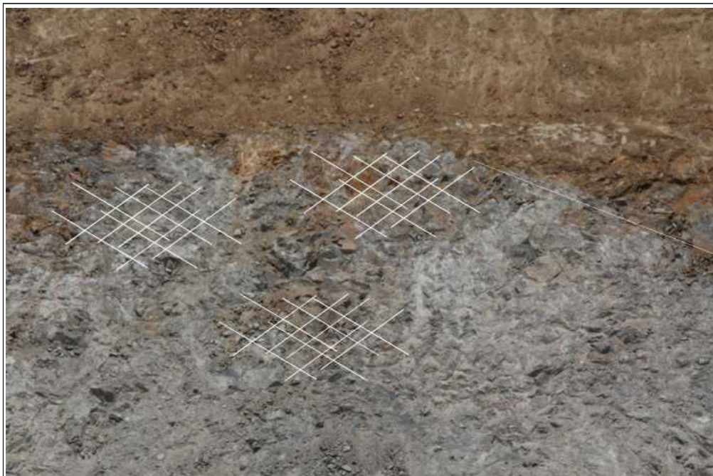
【그림 21】 C 영역 상세사진 (세편화된 암석)
