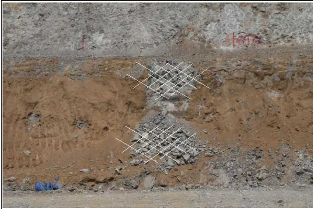
【그림 20】 C 영역 상세사진 (세편화된 암석)
